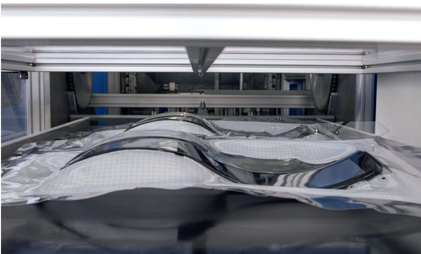
Bild 2. Die FIM-Maschine für die 3D-Heißumformung großformatiger PC-Bögen arbeitet mit 60 bar
