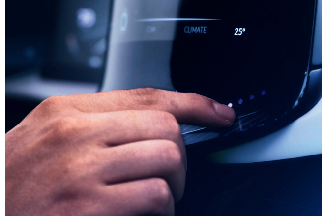
Bild 4. Oberflächentopografien auf der Blende erleichtern die Blindbedienung von Funktionen auf dem Display. Dadurch ist der Fahrer weniger vom Straßengeschehen abgelenkt (© Continental)
